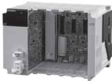
3 选购插槽 型号：JEYRM-MBUX023A60 JEYRM-MBUX023D60 重量：800g
